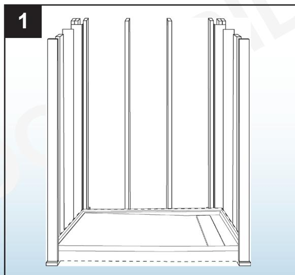
2. Après avoir appliqué l'ensemble mince, remplacer les cales (si nécessaire) au bon endroit et mettre le bac en place. S'assurer que le plancher repose au niveau de l'ensemble mince et des cales et qu'il est centré dans l'ouverture.
